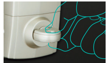
上下にあるスイッチを指先で押しながら回す スイッチ式防犯サムターン
